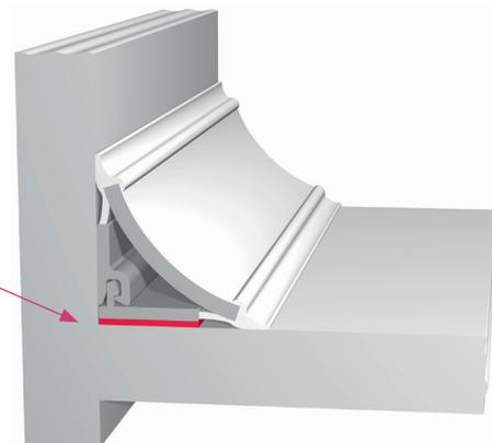
Pritisnite profil na mjesto tako da se ljepljiva traka zalijepi za zid, ali ne na radnu površinu.
